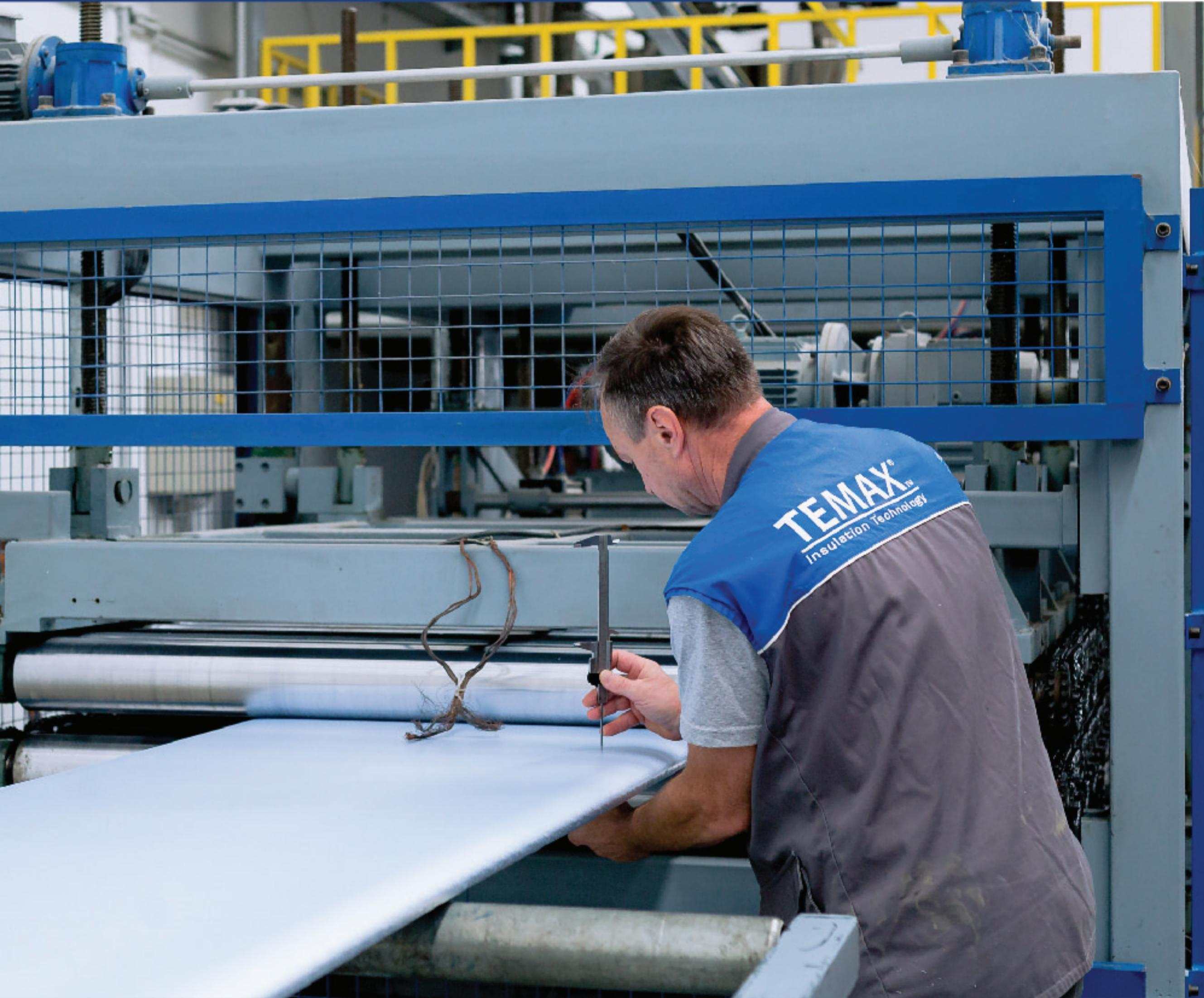
Temax XPS-platen met glad oppervlak worden niet verder bewerkt, maar alleen in een bepaalde vorm gesneden. De randen zijn volledig recht afgesneden. Dankzij hun sterke celstructuur zijn ze geschikt voor bescherming tegen langdurige blootstelling aan water. Rabbetkanten worden gecreëerd door de randen van de plaat op de geëxtrudeerde plaat te snijden. Dankzij de vouwranden blijven de isolerende eigenschappen behouden en is de plaat gemakkelijk te verwerken.
