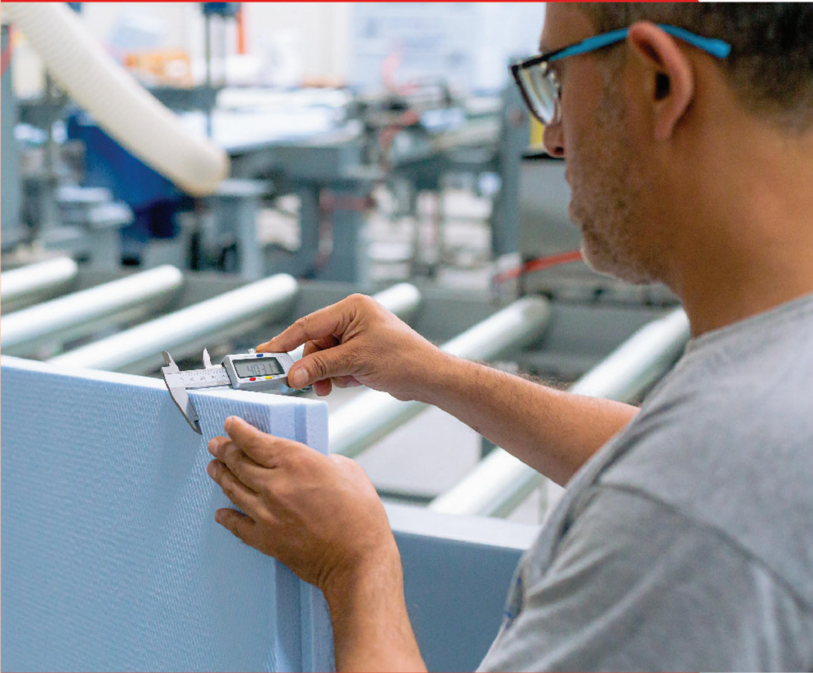
Temax XPS gewafelde oppervlakken zijn speciaal ontworpen door ons deskundig team. In een dunne oppervlaktelaag wordt een gewafeld patroon gegraveerd. Deze vorm behoudt zijn isolerende eigenschappen gedurende lange tijd en zorgt voor gebruiksgemak tijdens de toepassing.
