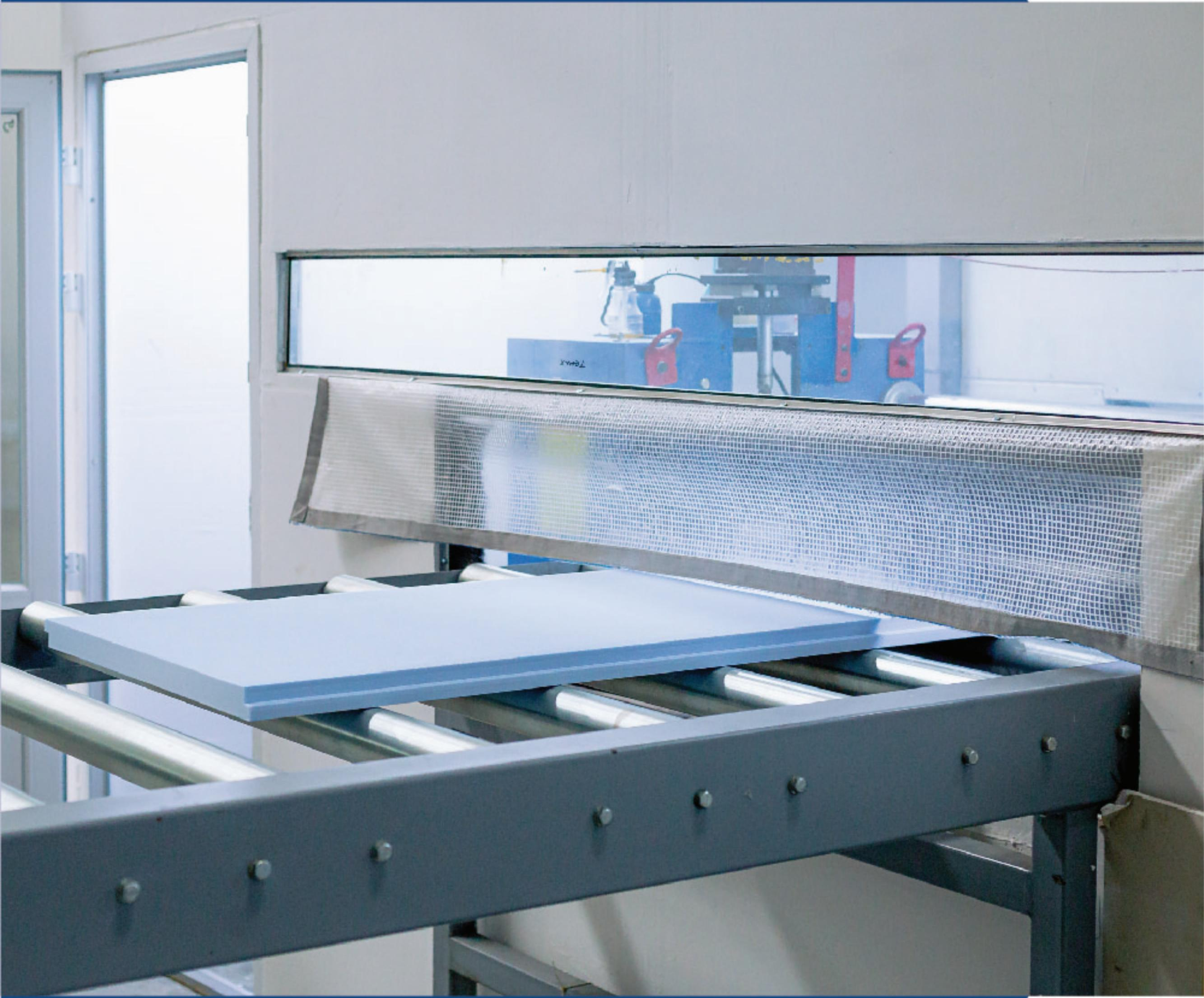
Temax XPS platen met kanaaloppervlak worden op verzoek geproduceerd. Deze kanalen worden gegroefd met hoogtechnologische snijapparatuur. Een product met een deze soort oppervlak bevordert de absorptie van de lijm en wordt daarom meestal gebruikt in toepassingen waar de eindlagen extra hechting nodig hebben. Dankzij de vouwranden met sponning behoudt het zijn isolerende eigenschappen en biedt het gemak bij het aanbrengen.
