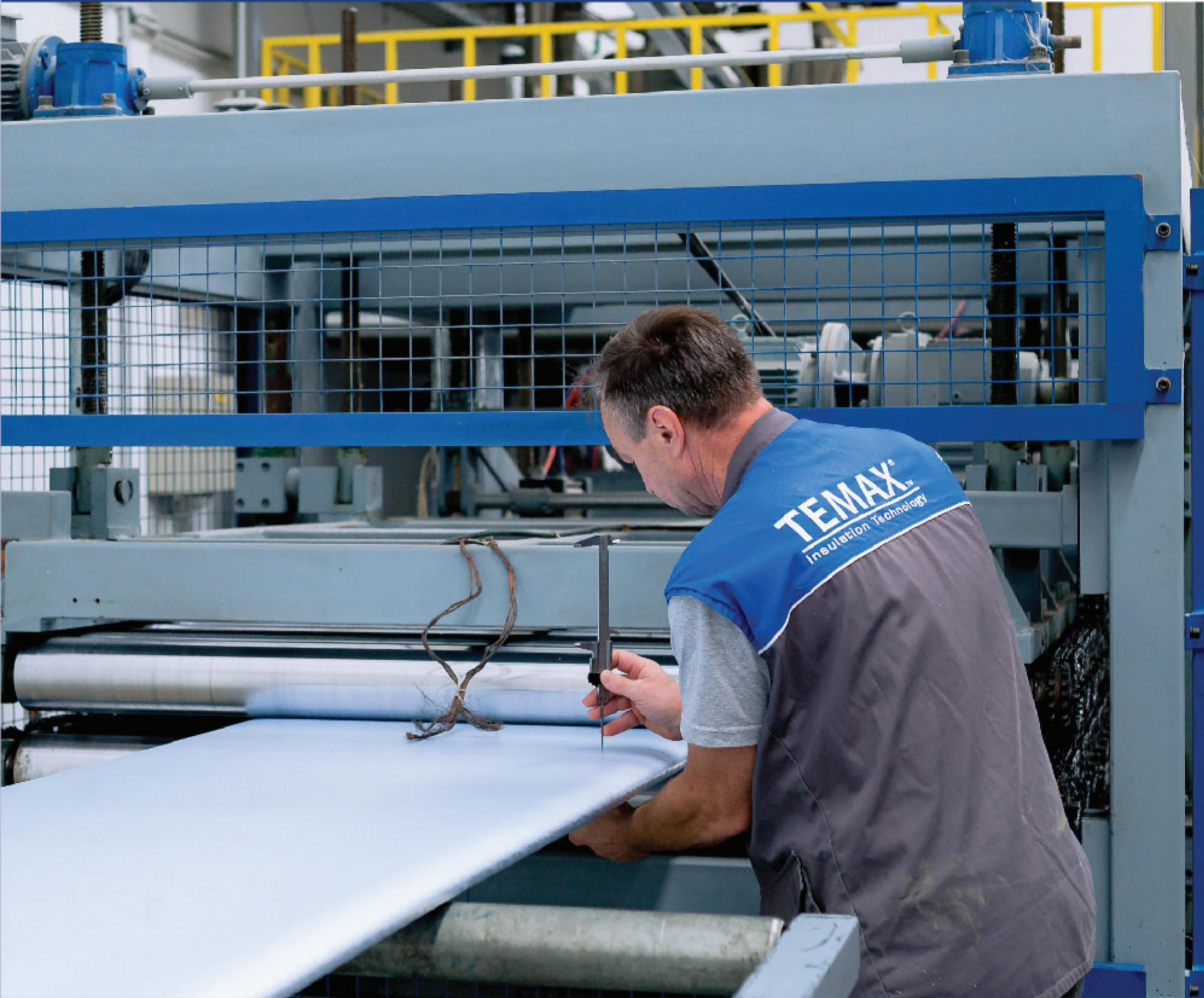
Temax XPS ploče sa glatkom površinom nisu dodatno obrađene, već se samo režu u određeni oblik. Rubovi su potpuno ravnog reza. Zahvaljujući snažnoj čelijskoj strukturi, pogodni su za zaštitu od vlage. Zahvaljujući preklopnim rubovima, ploča čuva svoja izolaciona svojstva i pruža praktičnost prilikom primjene.
